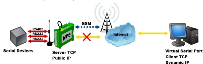
Komunikacja z konwerterem - konwerter NPE w trybie serwera o publicznym adresie IP
