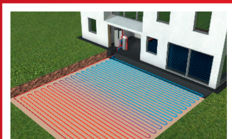
Poziomy wymiennik gruntowy
