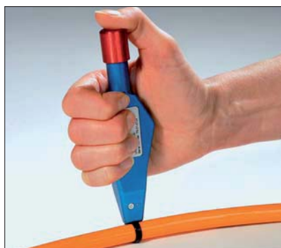
...naciśnij przycisk popychacza stale dociskając narzędzie...
