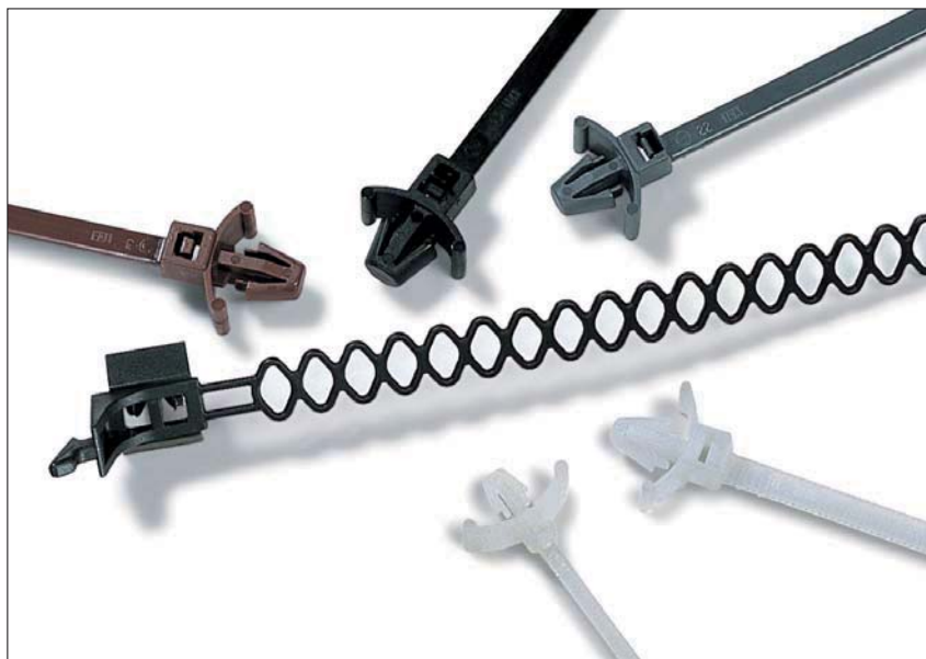
Opaski z mocowaniem kotwicznym przeznaczone są do blach o grubości od 0,5 mm do 4,0 mm i do otworów o średnicy od 4,65 mm do 8,2 mm.
