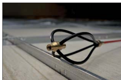
Trzepaczka ułatwia przeciąganie przewodu po nierównej powierzchni.
