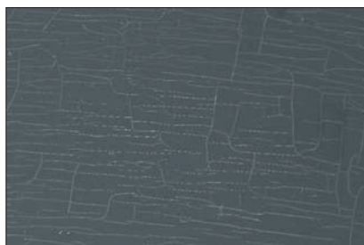
Struktura materiału została uszkodzona na wskroś przez promieniowanie UV.
