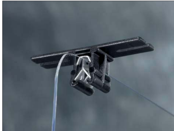
Przewody mogą być zamocowane do elementu mocującego przy pomocy opasek lub taśmy, a następnie poprzez element EdgeClip do krawędzi blachy lub tworzywa sztucznego.
