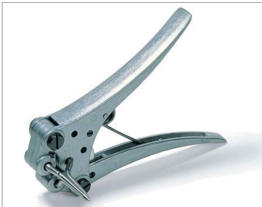
Szybki, bezpieczny montaż przy pomocy rozwieraka trójzębnego NA.
