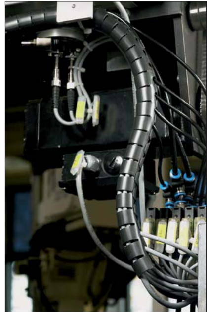
Elastyczny na całej długości, wykonanie odgałęzień możliwe w dowolnym miejscu.
