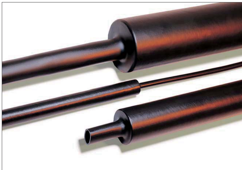
Średniościenna rura termokurczliwa TREDUX MA47 z klejem o skurczu 4:1.
