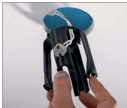
Zamontuj przewody zasilające w uchwycie, ściśnij wszystkie cztery ramiona do środka i włóż do otworu w płycie.
