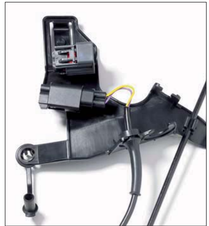
Rozwój produktów indywidualnych dla klientów: Specjalne mocowanie do przewodów paliwowych oraz złączy elektrycznych.
