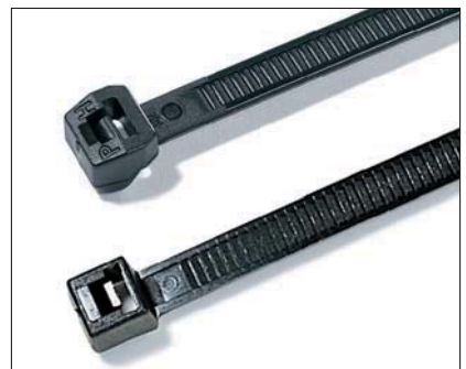
Modernizacja klasycznych opasek kablowych: Opaski kablowe serii T/LK są zastępowane opaskami z ząbkowaniem zewnętrznym, co zapewnia lepszą ochronę izolacji wiązanych przewodów.
